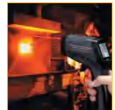
Distance (D) to Spot size(S) D:S=50:1(8869) Model 8869
